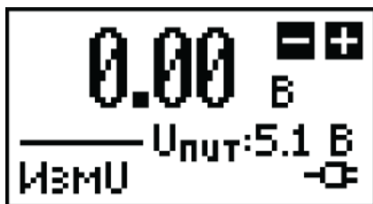
Рисунок 6.2 – Экран прибора в режиме измерения напряжения
